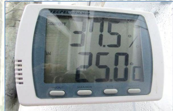
Termómetro digital con termohigrómetro incorporado
